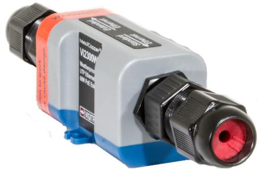
Der VI-UTP-2300WP überträgt 10/100Mbps Ethernet und PoE/PoE+ mit UTP, bzw. Cat-Kabel bis zu einer Distanz von 500m. Die Pass Through Technologie ermöglicht es, die PoE Speisung z.B. eines Midspans direkt über UTP, bzw. Cat-Kabel weiterzugeben. Die Geräte brauchen keine Software-Konfiguration. Der VI-UTP-2300WP ist in einem IP67 geschützten Gehäuse verbaut und so für die direkte Aussenmontage ohne zusätzlichen Anschlusskasten geeignet.
