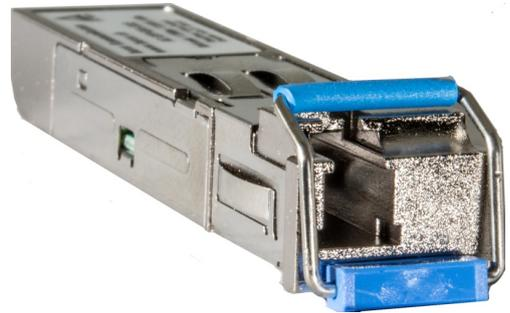
Les Small Form-factor Pluggables (SFP) servent comme petits modules standardisés pour les connexions réseau. Les dispositifs sont conçus comme des connecteurs pour des connexions réseau extrêmement rapides et peuvent être insérés dans divers switch et convertisseurs média.
