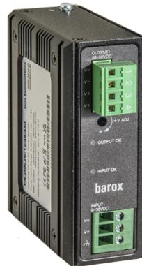
Ce convertisseur de tension industriel augmente une tension d'entrée de 9-36VDC à une tension de 48-55VDC adaptée au PoE et au PoE+. Cela permet d'alimenter par exemple des injecteurs PoE ou des convertisseurs de médias à des endroits où seules des tensions entre 9-36VDC sont disponibles. Le convertisseur de tension est conçu pour un montage mural ou sur rail DIN. Grâce à ses petites dimensions et à sa grande plage de températures de fonctionnement, il convient surtout pour l'extérieur.
