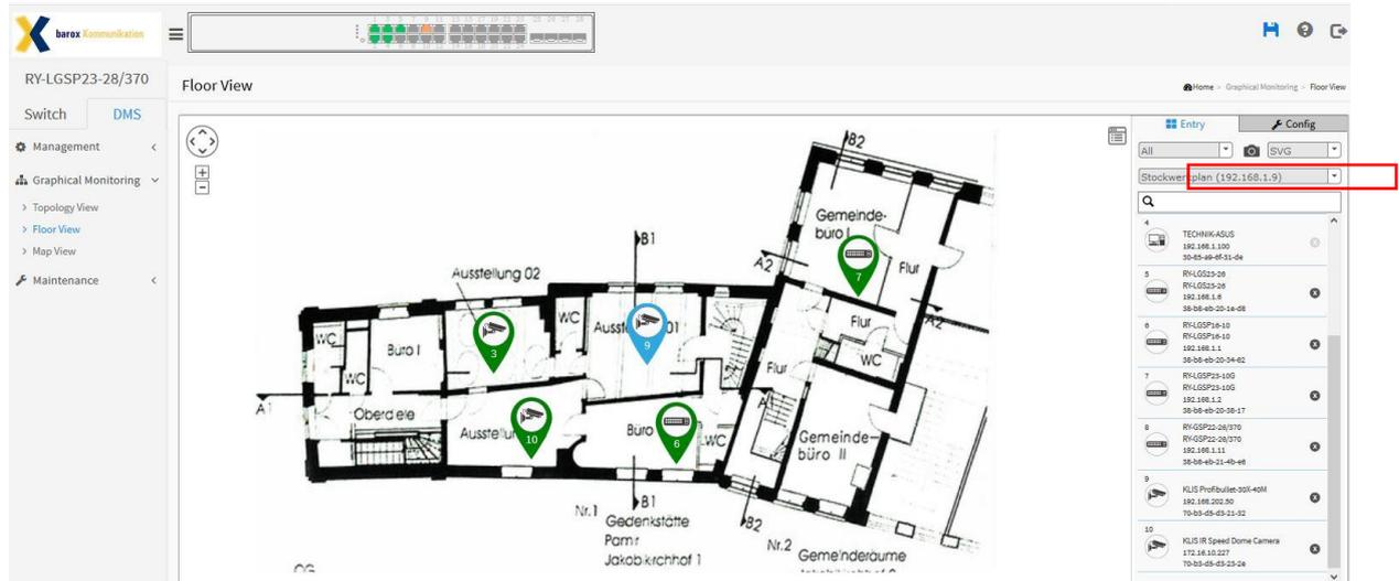
Um die Kamera oder den Switch im Plan zu platzieren ist nur das entsprechende Gerät in der Liste per Mausklick auszuwählen und im Plan zu platzieren, fertig.
