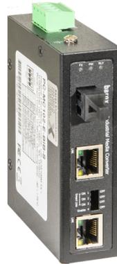
Dieser industrielle Medienkonverter wurde eigens für Anwendungen mit hoher Datenlast, wie z.B. Video over IP, Video streaming entwickelt. Die kompakte Bauform, der grosse Temperaturbereich und die hohe Flexibilität machen diesen Medienkonverter ideal für abgesetzte Standorte. Der Medienkonverter hat einen fixen optischen Port und zwei Kupferports mit 10/100TX. Durch das mitgelieferte Montagezubehör lässt sich der Medienkonverter einfach auf einer Hutschiene oder an eine Wand montieren.
